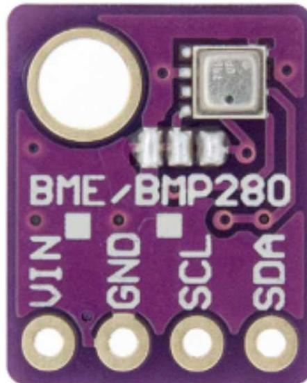
BME280 — датчик давления, температуры и влажности.
