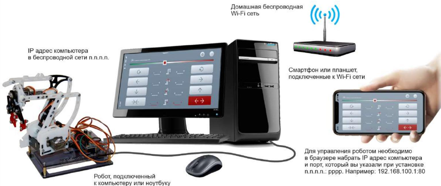
Для подключения к пульту управления роботом на мобильном устройстве необходимо запустить браузер и в адресной строке набрать адрес пульта управления, который Вы установили на компьютер.
