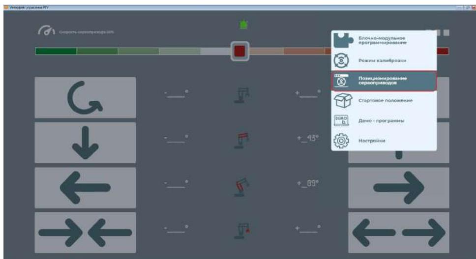
Затем в открывшемся окне нажать кнопку **“Установить среднее положение”**. Подключенные сервоприводы будут установлены в среднее положение. Появится сообщение об успешном позиционировании сервоприводов. Для того чтобы отменить позиционирование необходимо закрыть окно позиционирования.
